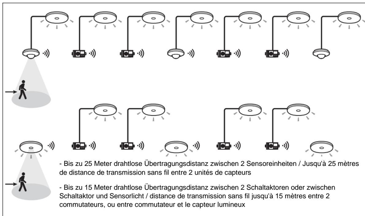
Innerhalb der Lichtsteuerungsanwendung schaltet jeder Aktor oder jede Sensorleuchte der gleichen Gruppe # und Adresse #, die durch einen 2.4 GHz Impuls aktiviert wird, die gesamte Gruppe ein. Nach der Einschaltung bleibt das Licht für die eingestellte Zeit eingeschaltet.
